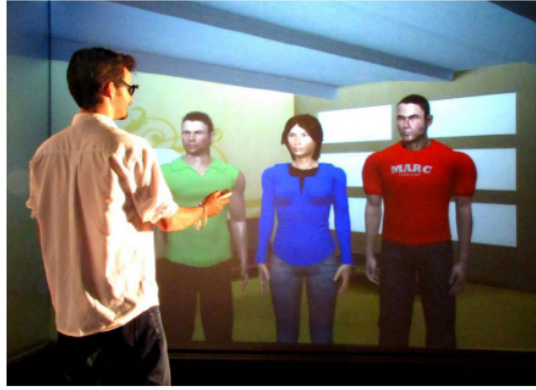
Environnement immersif audiovisuel pour l'interaction affective en temps-réel par intégration des personnages virtuels MARC (Multimodal Affective Reactive Characters ; M. Courgeon, J.-C. Martin, C. Jacquemin) dans la plateforme SMART-1 2 (a Spatial Multi-users Audio-visual Real-Time Interactive Interface ; M. Rébillat, B.F.G. Katz, E. Cordeel) The virtual characters of the MARC platform for real-time affective interaction (M. Courgeon, J.-C. Martin, C. Jacquemin) integrated in the SMART-1 2 platform providing an immersive audio-visual rendering based on "Wave Field Synthesis" (M. Rébillat, B.F.G. Katz, E. Cordeel)
